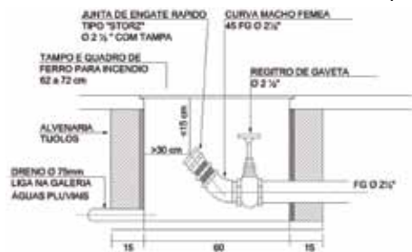
Detalhe e Hidrante de recalque tipo passeio
