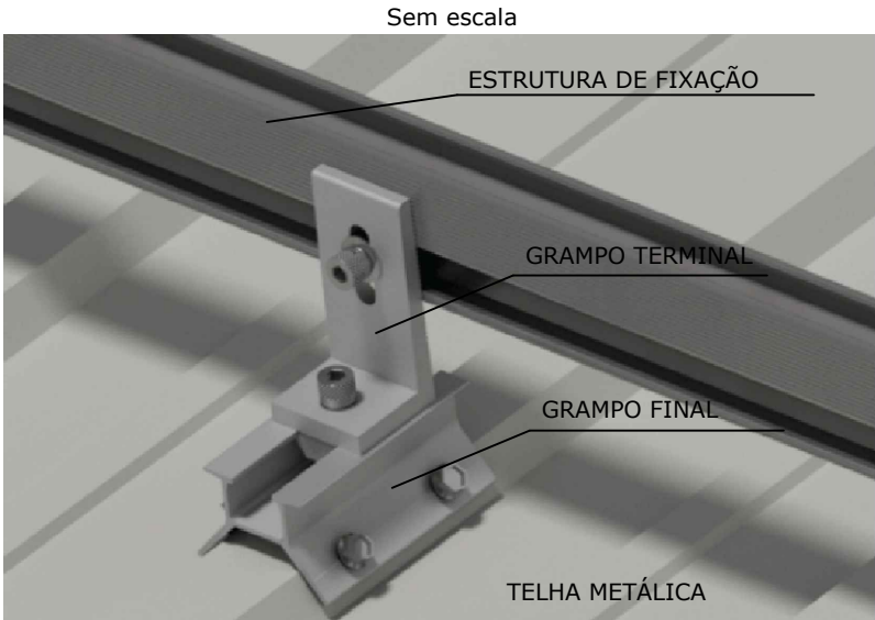
Detalhe de Fixação dos Módulos Fotovoltaicos
